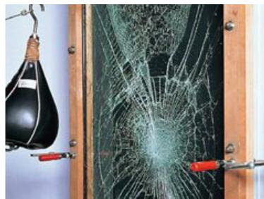
ガラスに特殊中間幕を挟み込み、防犯機能を向上。破壊試験でもガラスは割れますが、貫通穴はあいておらず、ドライバーによる「こじ破り」、ボールなどによる「打ち破り」に効果があります。
